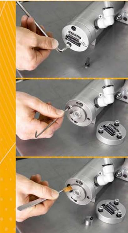
Der Motor verbleibt während des Lamellenwechsels im Einbauzustand – das spart wertvolle Fertigungszeit.
