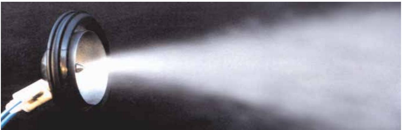
DUSTEX®-Dispersionsdüsen sind in 3 Größen, mit druckabhängigen Wasserdurchsätzen von 5 - 120  $\text{l}/\text{h}$  erhältlich. Der Wasserdruck wird auf 0,5 - 2 bar geregelt. Der übliche Durchsatzwert der Dispersionsdüse 2507 liegt bei 25  $\text{l}/\text{h}$  (Einstellwerte: 0,5 bar Wasserdruck / 2 bar Luftdruck). Der Druckluftdurchsatz je Düse beträgt 5 - 12  $\text{Nm}^3/\text{h}$  bei 2 - 4 bar.
